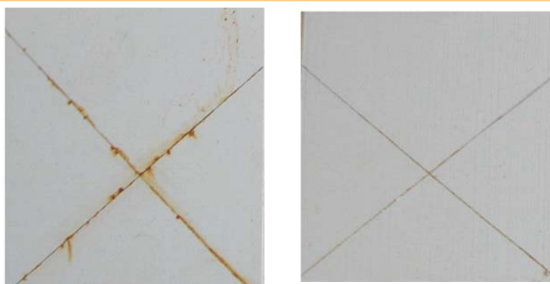
Рис. 2. Внешний вид покрытий на основе акриловой ВД-эмали после выдержки в кислой среде в течение 72 ч, содержащей: а — 8 % антикоррозионных пигментов; б — 4 % антикоррозионных пигментов и 2 % Synthro-cor AM35
